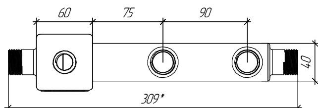
\* Используется для разметки отверстий кронштейнов
