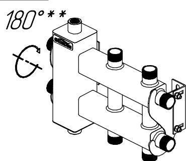
\*\* Для верхней подводки потребителей допускается перевернуть коллектор на 180° по горизонтальной оси
